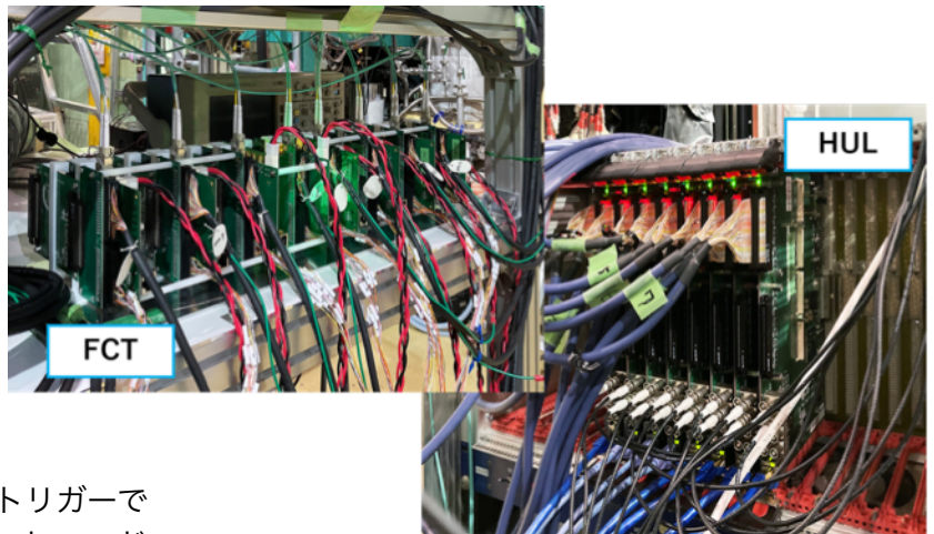
写真の説明：Esysが開発した連続読み出しTDCを実装した回路の写真。FCTとHULにそれぞれ異なったデザインのTDCが実装されている。
