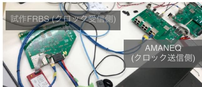
写真の説明：g-2の試作ボード間でのMIKUMARIの接続試験の様子。違う回路間でCDCMの変調クロックからクロックを復元し同期が取れる事を確認した。
