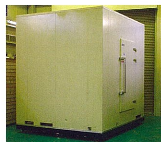
実験研究用磁気シールドルーム 構築方式: パネル式 材質: パーマロイ ルーム内寸法: 2400(W)×2900(L)×2800(H)mm
